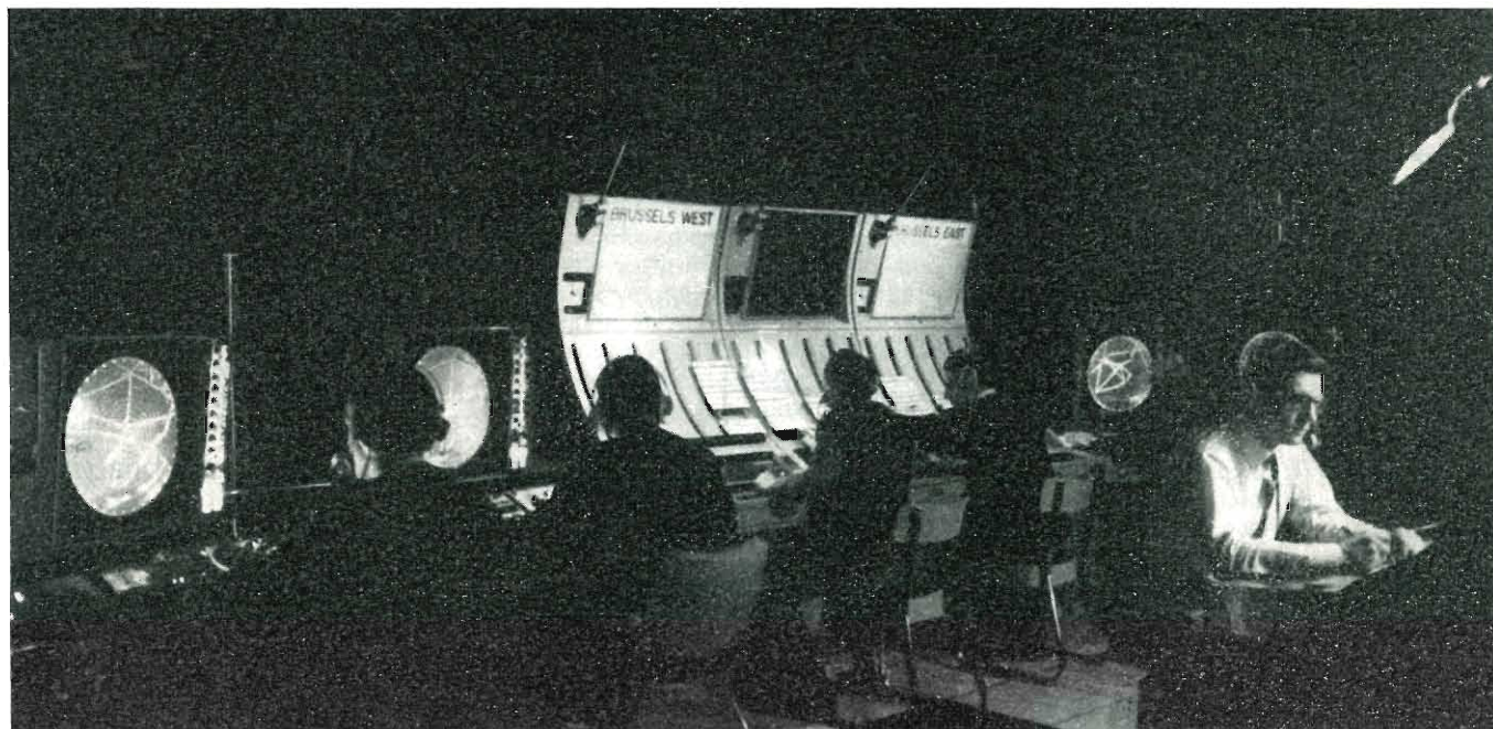
Fig. A - Complesso indicatore dei posti di controllo Plessey al Centro Sperimentale dell'Eurocontrollo a Bretigny in Francia. Gli indicatori presentano punti di riferimento, segni di richiamo e livelli di volo di aerei, sia in un'intera zona di controllo, sia in sezioni selezionate. La velocità di aggiornamento è di una volta ogni 10 secondi.
