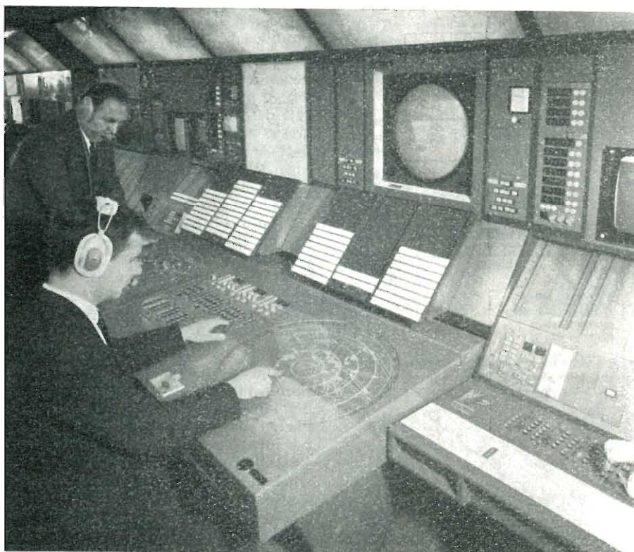
Fig. 4 - Catena di controllo comprendente apparati indicatori luminosi Digitrace Plessey.
